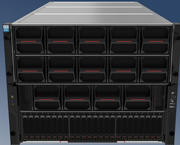
R6900G5是一款面向大模型训练领域应用的GPU服务器，支持2颗第四代英特尔®至强®可扩展处理器，拥有大容量内存和超高速I/O接口，支持HGX-8-H20、BR106OAM、Gaudi2C加速卡，应用于自然语言大模型训练、人工智能、高性能计算、金融建模、通信 等领域。超强的计算能力、高速的互联带宽给用户提供一个高性能、高稳定的超算产品。
